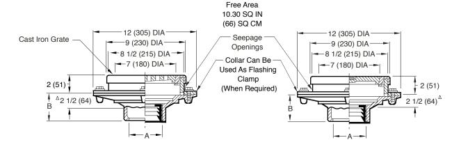
Fig. 9205C . . . . . CAULK OUTLET Fig. 9205Y . . . . . NO-HUB OUTLET
