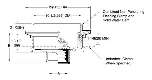
Fig. 3970C . . . CAULK OUTLET Fig. 3970Y . . . NO-HUB OUTLET Fig. 3970T . . . THREADED OUTLET
